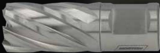
Norton-Kernbohrer arbeiten vorzugsweise mit Magnetbohrern oder Bohrmaschinen. Ein Kernbohrer arbeitet anders als herkömmliche Spiralbohrer. Er schneidet eine ringförmige Nut am Rand des Lochs und hinterlässt einen festen Kern in der Mitte, der durch den Zentrierstift ausgeworfen wird. Dies ermöglicht ein schnelleres und einfacheres Bohren größerer Löcher und eine deutlich längere Lebensdauer des Werkzeugs.
