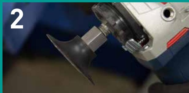
Entfernen Sie den Metallschaft von dem Stützteller für SpeedLok-Scheiben und schrauben Sie den Adapter auf. Dann können Sie den Stützteller direkt auf dem Winkelschleifer verwenden.
