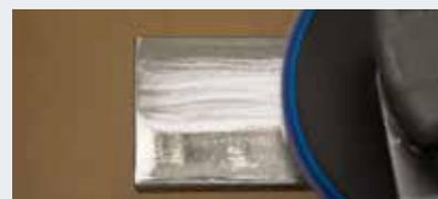
Supersize-Beschichtung für einen kühleren Schnitt sorgt für eine bessere Werkstückqualität und ohne Aufbrennen
