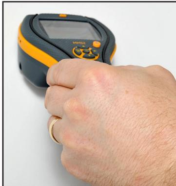
Abbildung 2: Verwendung des Stift-Feuchtemessgeräts
