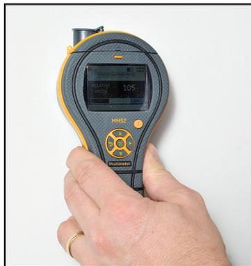
Abbildung 3: Messung von relativer Feuchtigkeit
