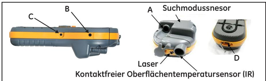
Abbildung 1: Zubehörteile für Messköpfe und Sensoren
