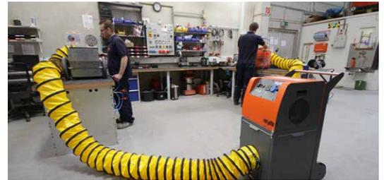
**Absaugung an bis zu 3 Arbeitsplätzen gleichzeitig mit nur einem Gerät**
