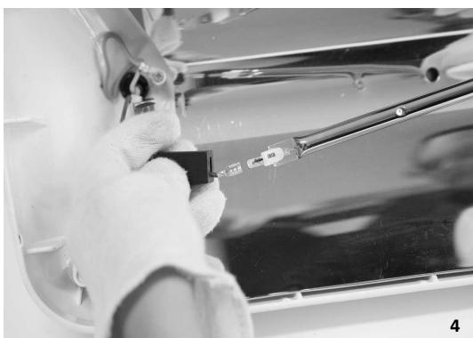
4. QUITAR LAS DOS CÁPSULAS ELASTOTÉRMICAS QUE CUBREN EL FINAL DE LA BOMBILLA Y DESCONECTAR LOS DOS FASTON QUE UNEN LOS CABLES A LA BOMBILLA. (SI LAS CÁPSULAS UTILIZADAS RESULTAN AGOTADAS, ESTAS DEBEN SER QUITADAS CORTANDO LOS CABLES JUNTO A LOS DOS FASTON)
