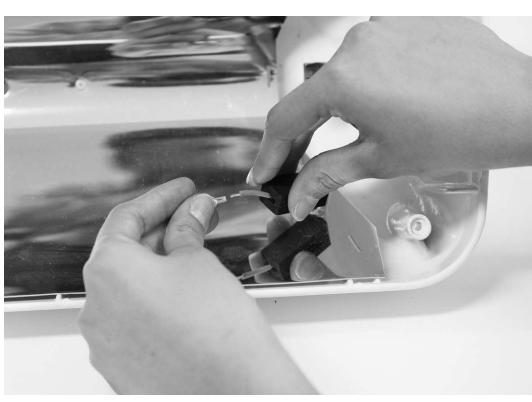
6. CONECTAR LOS FASTON MACHOS DE LA NUEVA BOMBILLA CON LOS DE LOS DOS CABLES, REVESTIRLOS CON LAS CÁPSULAS ELASTOTÉRMICAS Y VOLVER A COLOCAR LA BOMBILLA EN LA SEDE DE LOS RESORTES.
