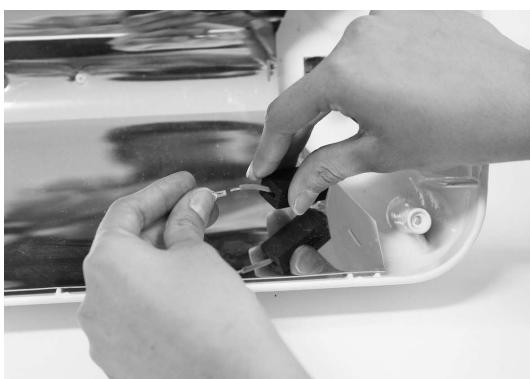
6. DIE FLACHSTECKER DER NEUEN LAMPE MIT JENEN DER BEIDEN KABEL VERBINDEN, DIE DICHTUNGEN ÜBERZIEHEN UND DIE LAMPE IN DEN SITZ DER BEIDEN FEDERN EINSETZEN.
