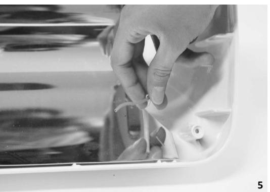
5. INTRODUCIR LAS CÁPSULAS ELASTOTÉRMICAS DE REPUESTO EN EL LUGAR DE LAS QUITADAS, PELAR LOS CABLES 5/6 mm, COLOCAR LOS NUEVOS FASTON DE REPUESTO Y APLASTARLOS SOBRE LA PARTE PELADA DE LOS CABLES. PRESTAR ATENCIÓN A NO TOCAR LA BOMBILLA CON LAS MANOS DESNUDAS.
