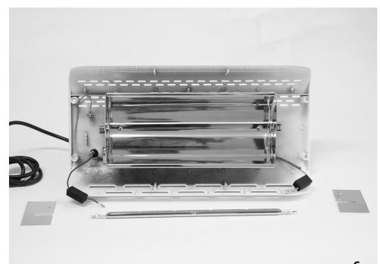
6. IBEI VERSCHLEISS NEUE DICHTUNGEN ANBRINGEN, DIE KABEL 5-6 mm ABISOLIEREN, DIE NEUEN FLACHSTECKER ANBRINGEN UND AM KABEL BEFESTIGEN
